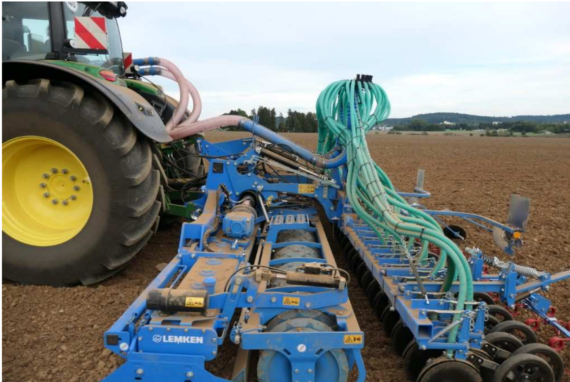
Verteilersystem Saat mit 2 Verteilerköpfen - 2 Wellrohrbögen Ø110 mm - mit Fahrgassenklappen - aufgebaut auf Scharschiene Fabr. Lemken
