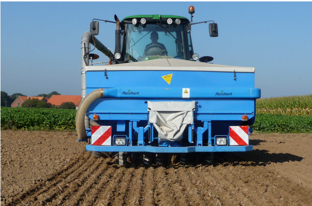
Walze, hydraulisch aushebbar (Güttler-Walze Ø560 mm) - Rückverfestigung - am Fronttank FT 2527 (Inhalt 2700 Liter, Tankbreite 2,50 m)
