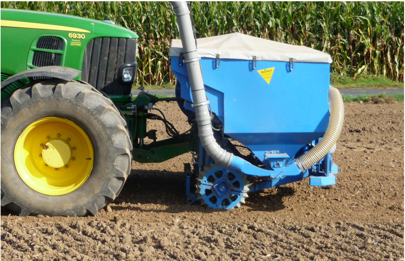
Walze, hydraulisch aushebbar (Güttler-Walze Ø560 mm) - Rückverfestigung - am Fronttank FT 2527 (Inhalt 2700 Liter, Tankbreite 2,50 m)
