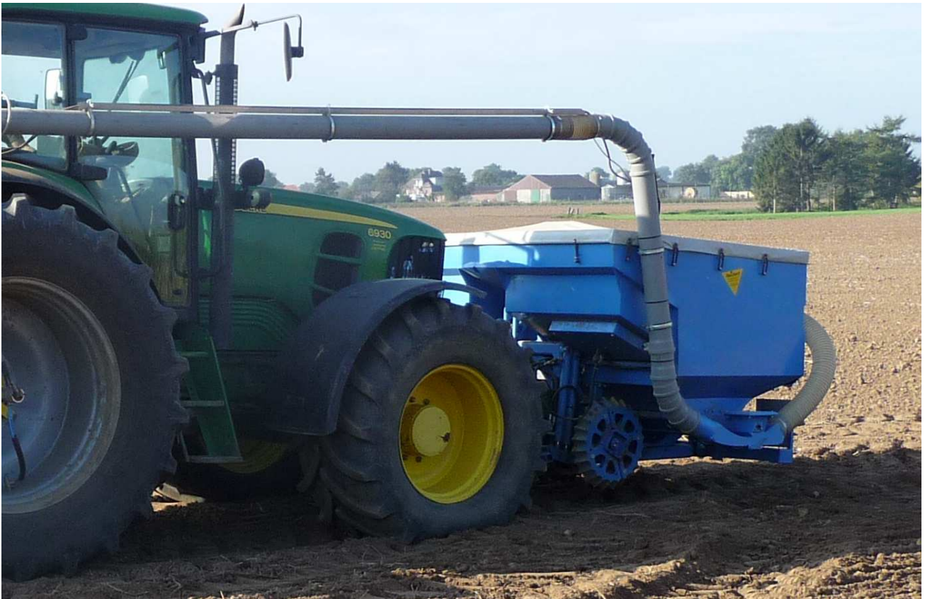
Walze, hydraulisch aushebbar (Güttler-Walze Ø560 mm) - Fronttank und Walze ausgehoben - am Fronttank FT 2527 (Inhalt 2700 Liter, Tankbreite 2,50 m)
