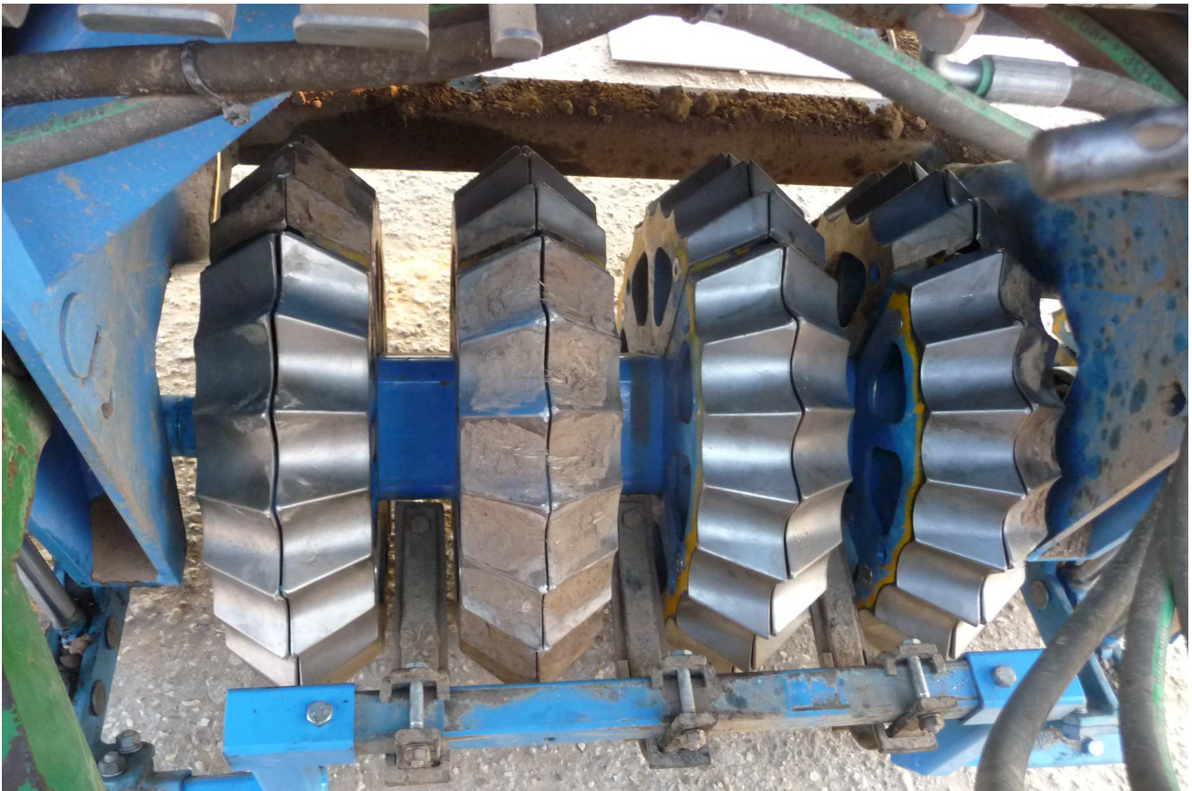
Walze, hydraulisch aushebbar (Güttler-Walze Ø560 mm) - Walzensterne Ø560 mm - mit Ausräumern
