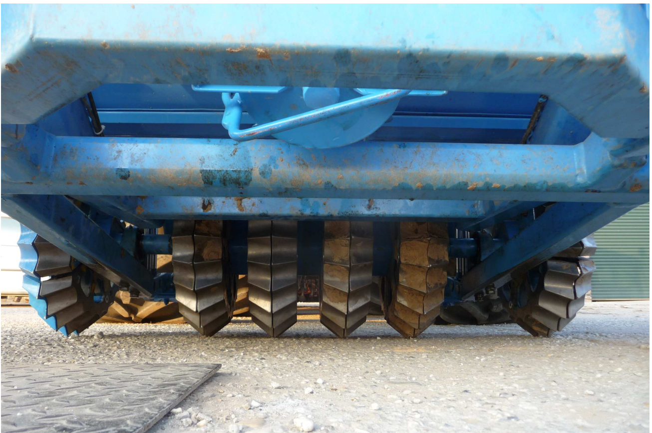
Walze, hydraulisch aushebbar (Güttler-Walze Ø560 mm) - Verteilung der Walzensterne - am Fronttank FT 2527 (Inhalt 2700 Liter, Tankbreite 2,50 m)
