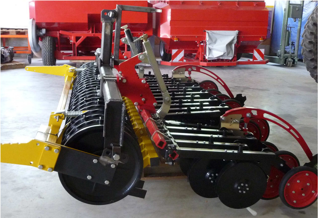
Säkombination Arbeitsbreite 3 m mit Anbaurahmen (Reichert) für Horsch-Scharschiene, passend auf jede Walze Säkombination zusammengestellt nach Kundenwunsch
