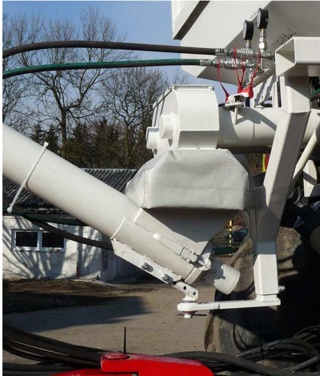
XEAT 1854 mit 2 Tankschnecken Tankschnecken-Zusammenführung Umladeschnecke Ø150 mm auf Drille
