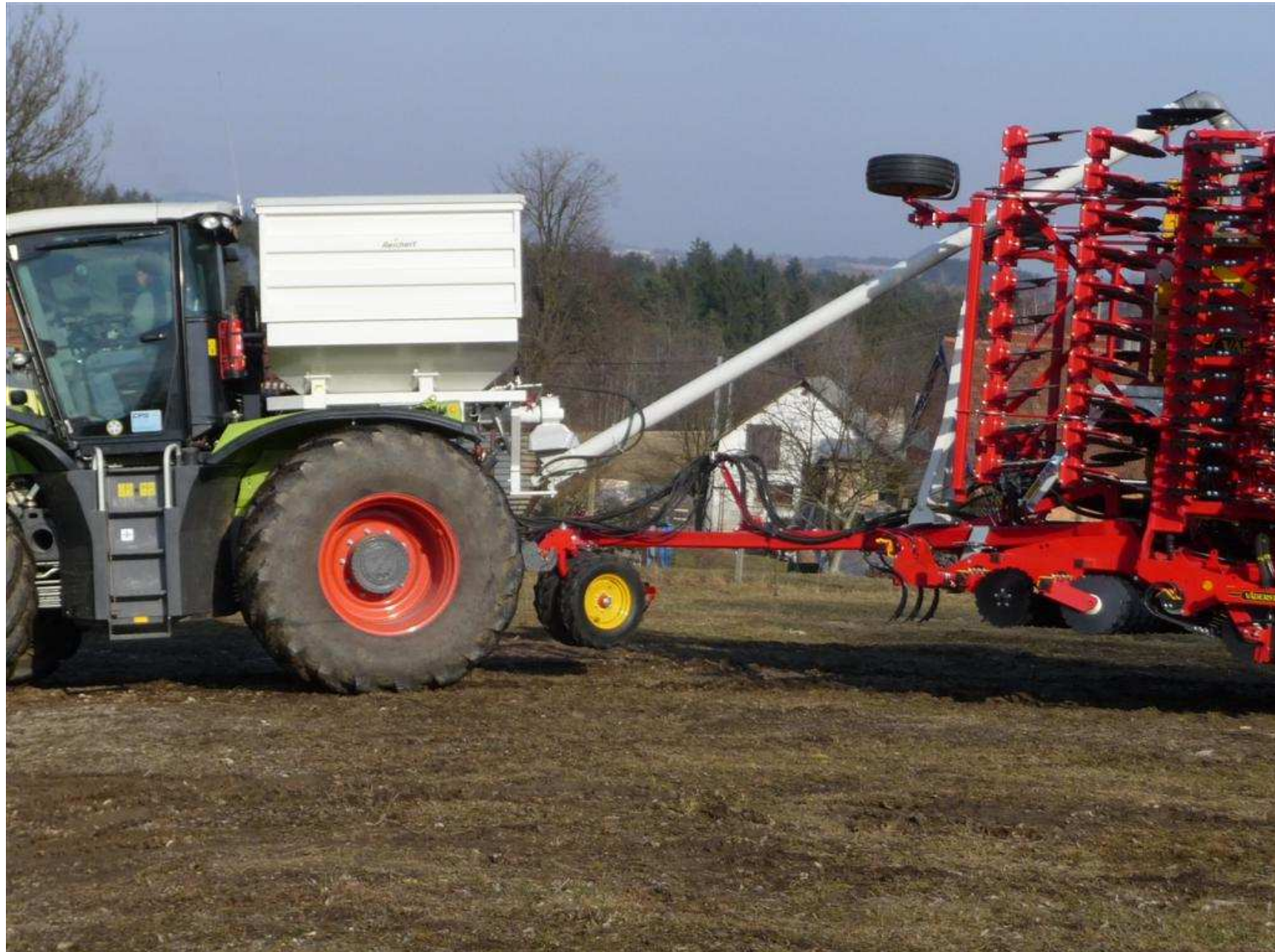
XEAT 1854 mit 2 Tankschnecken Tankschnecken-Zusammenführung
